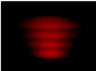
Im Beschleunigungsbereich der Röhre können die Regionen, in denen es zu Stößen zwischen Gasatom und Elektron kam, einfach beobachtet werden, da die angeregten Atom in den Grundzustand zurückfallen und dabei Photonen emittieren, die im einfachsten Fall mit dem Auge, sonst aber mit einem sonstigen Detektor zu registrieren sind (Abbildung 2.2).
