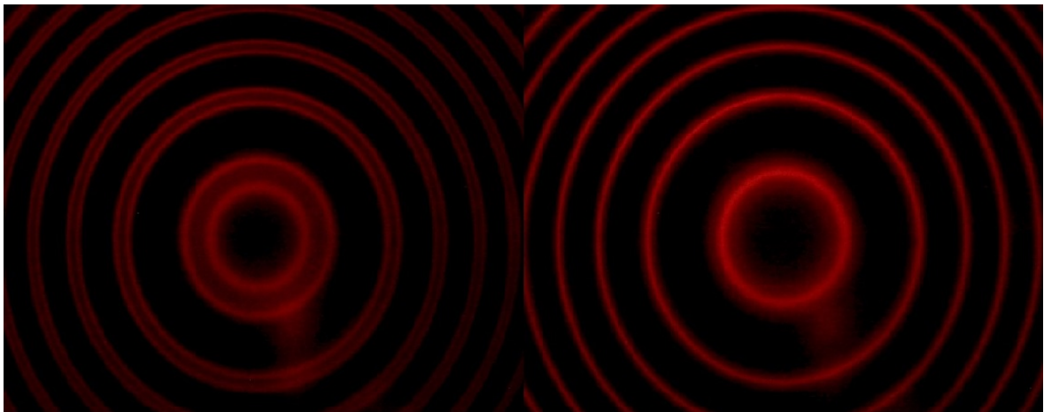
Abbildung 2.4: CCD-Kamera Aufnahmen des emittierten Lichts mit Rotfilter, bei transversaler Beobachtung mit einem Spulenstrom von I = 5\text{ A} , links mit dem Polarisationsfilter auf 0^\circ , rechts 90^\circ
