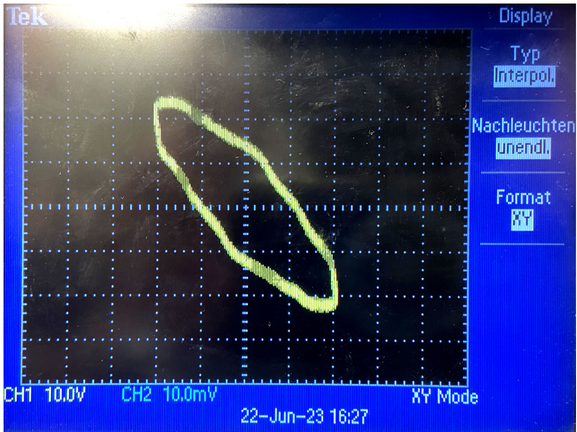
Abbildung 22: xy-Plot als Lissajous-Figure für Sekundärstrom I_2 = 1,5 \text{ A}
